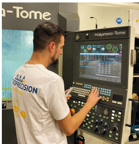
Fleroperationssvarv från Nakamura med tre revolverar, subspindel och stångmatare, programmeras via GibbsCAM.
